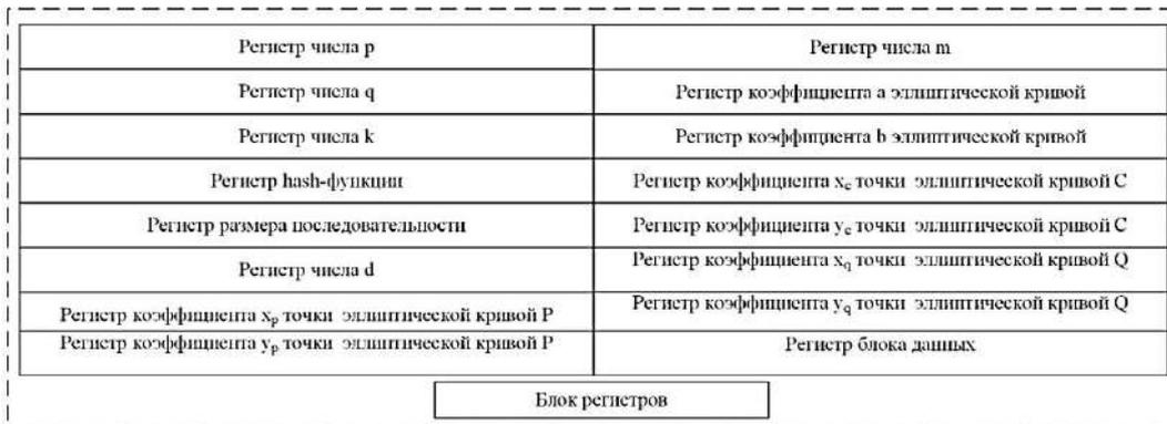
Рис. 1. Структура блока регистров разработанного модуля
