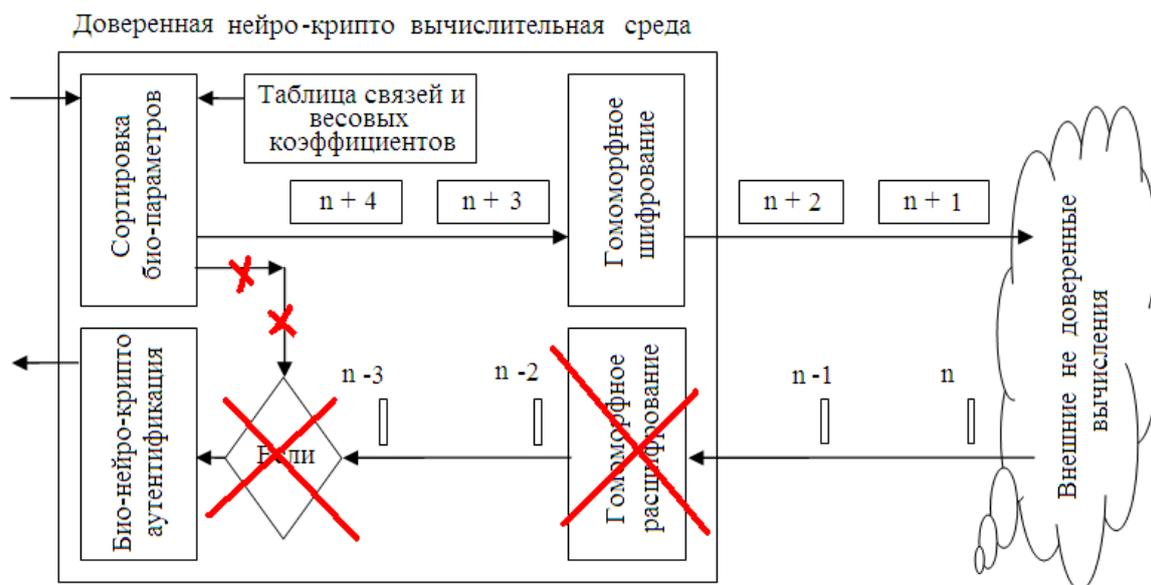
Рис 2. Доверенные вычисления, ориентированные на привлечение внешнего не доверенного вычислителя при обычном гомоморфном шифровании (гомоморфизм относительно трех типов операций «сложения», «умножения», «сравнения с порогоми»)
